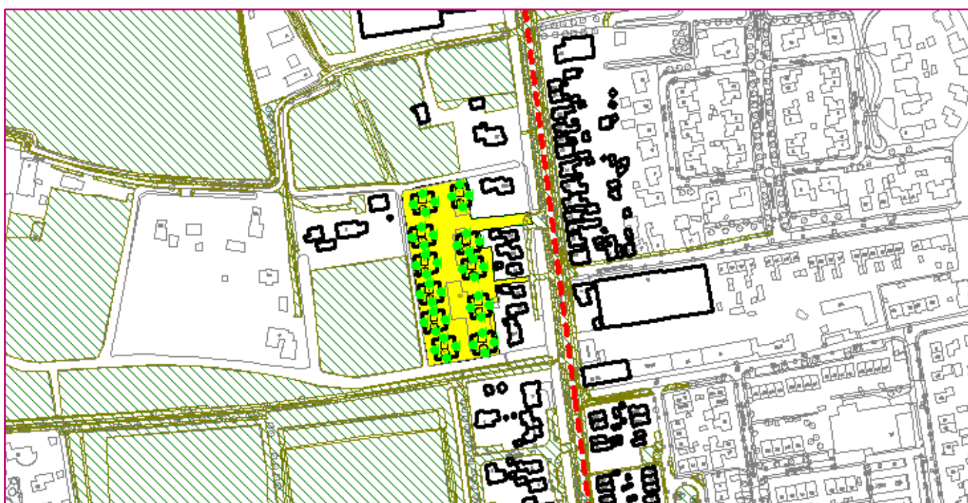
Figuur 3.1 Uitsnede akoestisch rekenmodel met rijlijn, toetspunten, gebouwen en bodemgebieden
