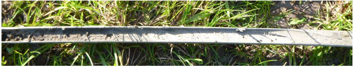
Figuur 8. Franeker, Marten Oostwoudstraat en Noorderbleek. Foto van het door zandlaagjes onderbroken kleipakket dat onderin de boringen is aangetroffen.
