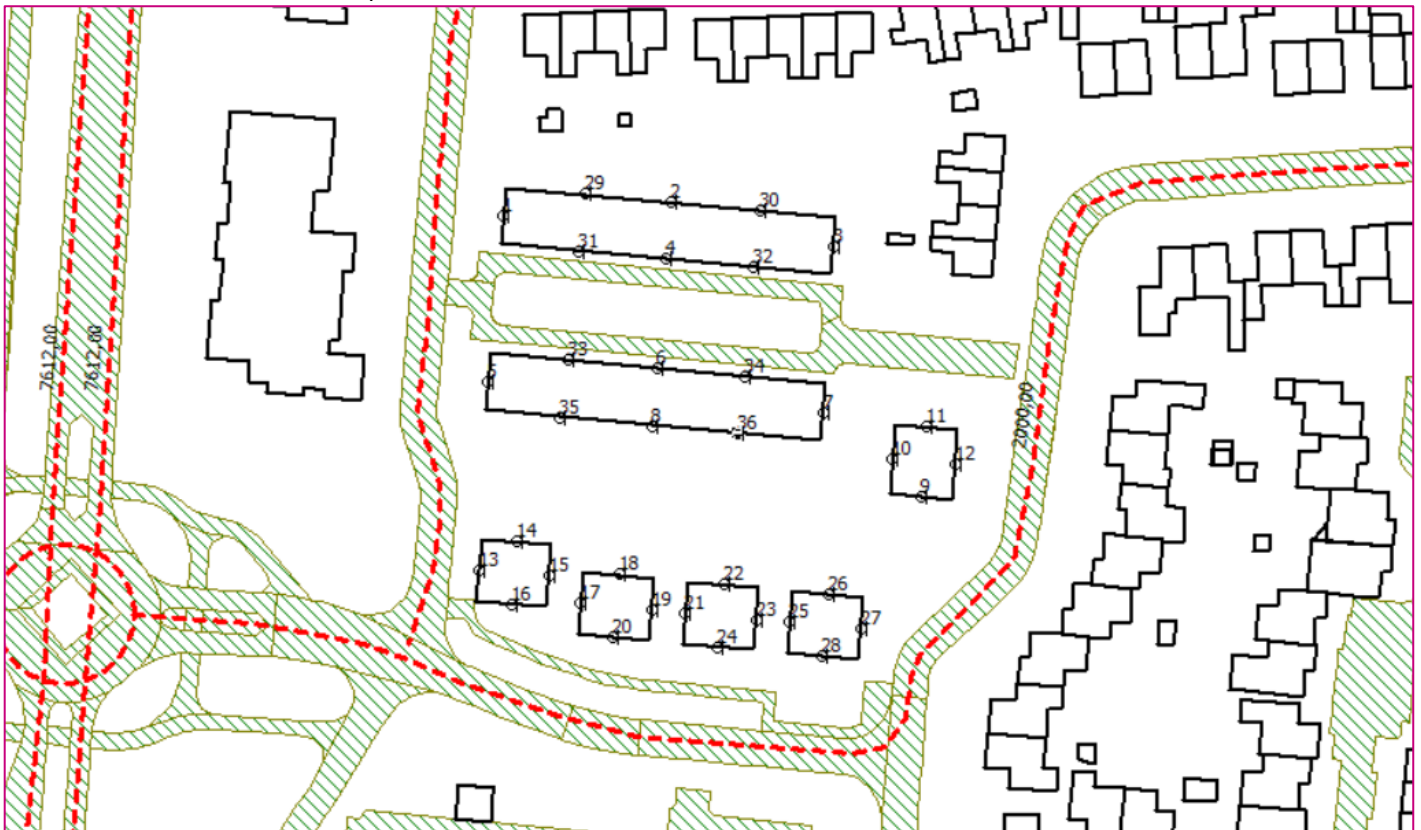
Figuur 4.1: overzicht van het akoestisch rekenmodel met de ligging van objecten, de harde bodemvlakken ( B_f = 0,0 ) en de toets-/rekenpunten
