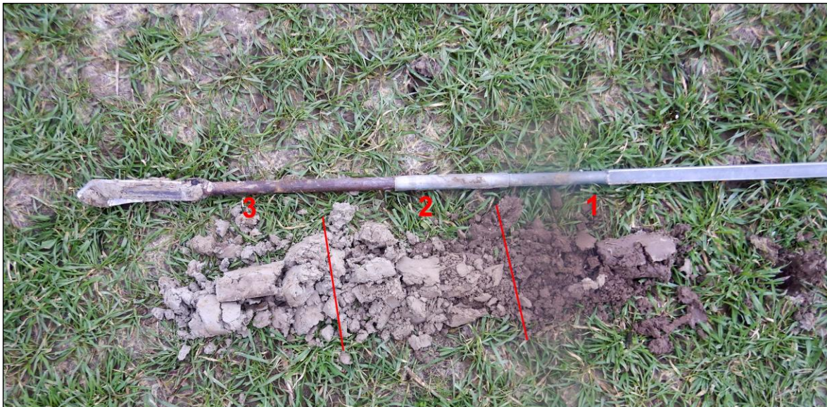
Afbeelding 16. Foto van boring 1.24 waarbij 1: bouwvoor; sterk zandige klei, 2: overgangslaag naar kwelderwal; sterk siltig, uiterst fijn zand, 3: kwelderwal; sterk siltig uiterst fijn zand
