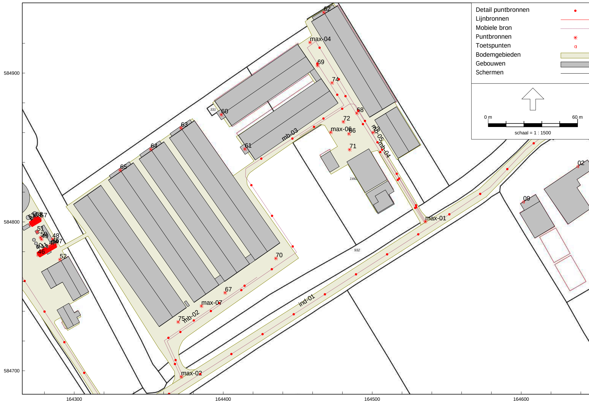
RBS: Detailoverzicht van het rekenmodel incl. geluidbronnen
