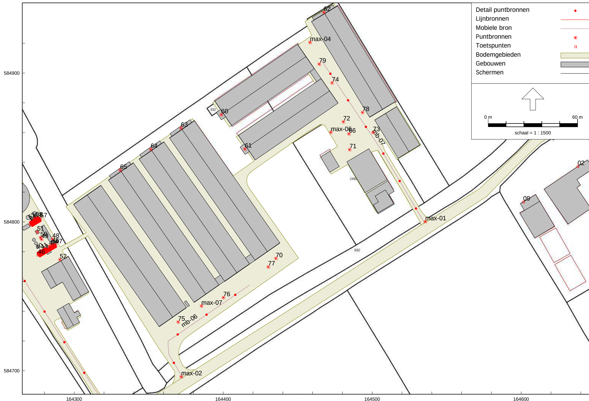
UBS: Detailoverzicht van het rekenmodel incl. geluidbronnen
