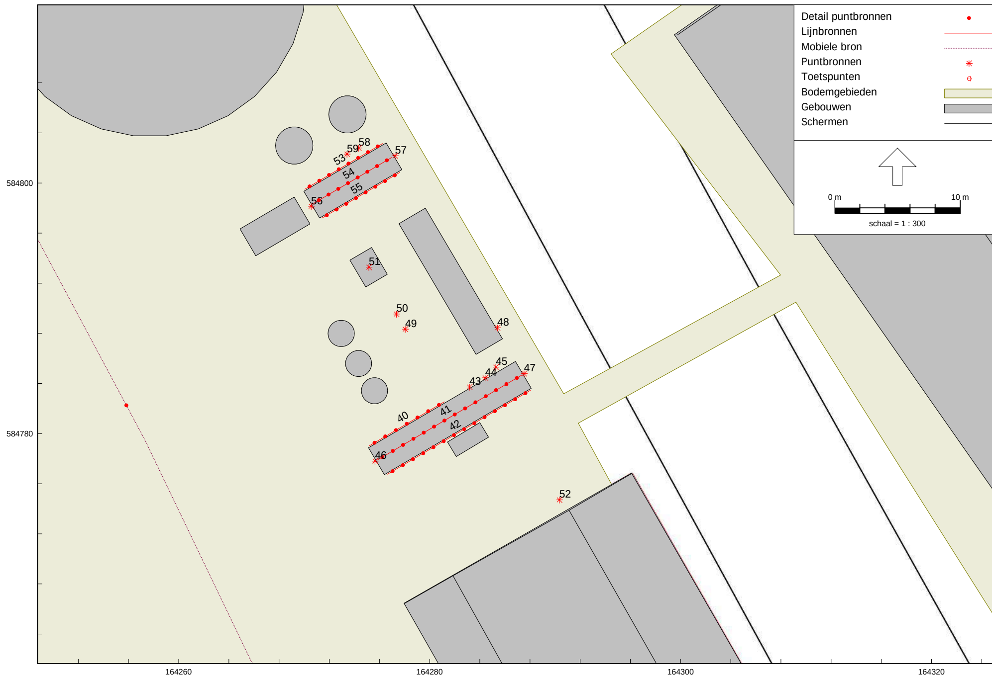
RBS: Detailoverzicht van het rekenmodel incl. geluidbronnen
