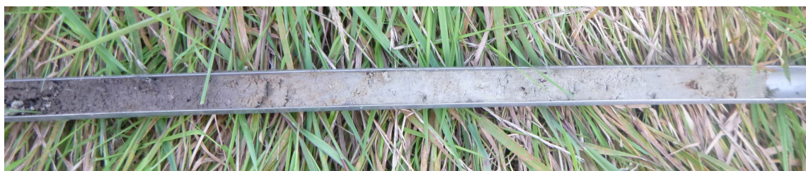
Figuur 12: Sexbierum, Hearewei: Het restant van de bouwvoor (links) zoals deze in boring 6 is aangetroffen met rechts daarvan klei op klei met zandlaagjes.
