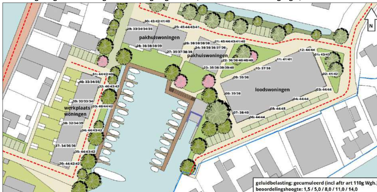
Afbeelding 3.2: gecumuleerde geluidbelasting wegverkeer (incl. 5 dB aftrek art. 110g Wgh.)
