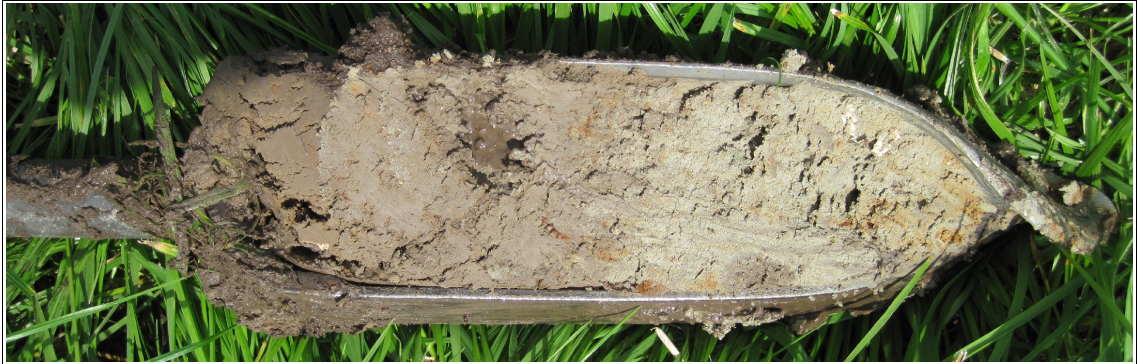
Figuur 4: Dronrijp, Westerpolder: boorkop boring 52. Monster van ongeveer 40 tot 53 centimeter beneden maaiveld. In de linkerhelft van de boorkop homogene, licht humeuze, sterk siltige klei. In de rechterhelft van de boorkop onderliggende, humusarme, zandige klei. De overgang tussen beide is abrupt.
