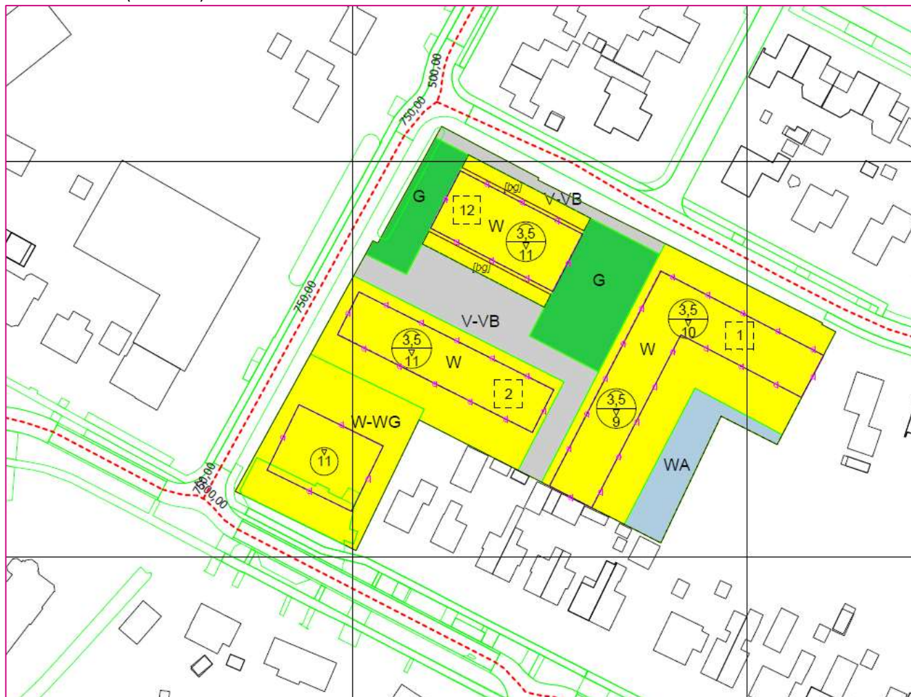
Figuur 2: globaal overzicht akoestisch rekenmodel met de ligging van de ingevoerde wegen en etmaalintensiteiten (aanname)
