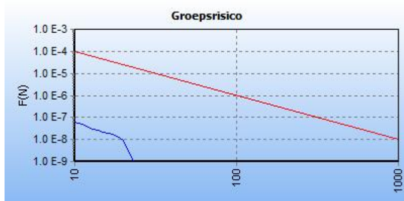
Figuur 2.8: fN-curve buisleiding A-521-deel-1, na planrealisatie
