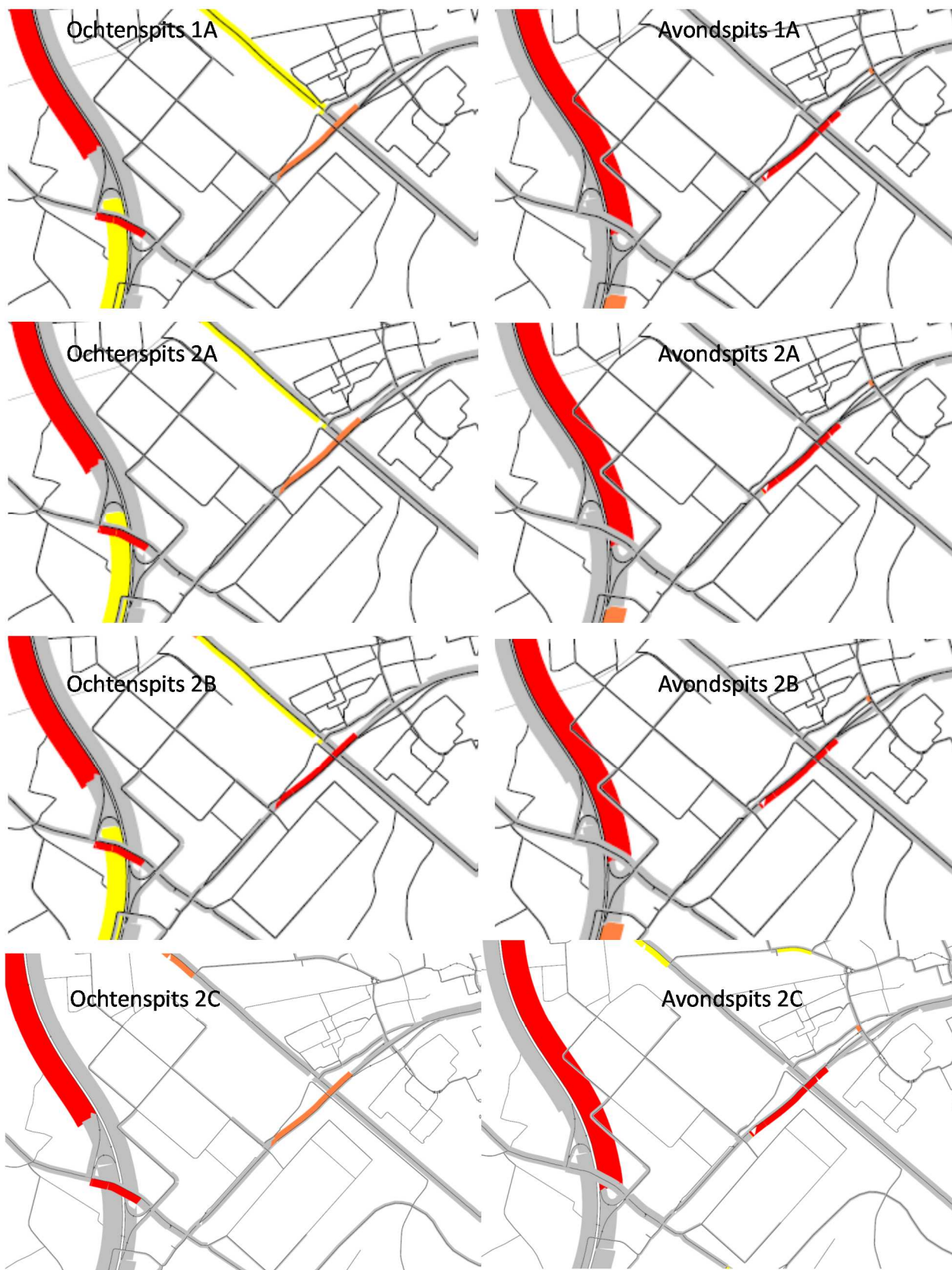
Figuur 9-14: Wegvakken met OV waar overbelasting optreedt ( I/C > 0,9 )
