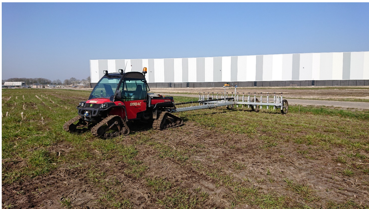
Figuur 2: Detectievoertuig zoals deze gebruikt is voor het uitvoeren van de passieve non real-time oppervlakedetectie.
