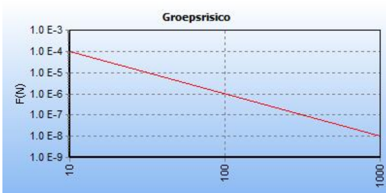
5.5 Figuur 5.5 FN curve voor 7707_leiding-Z-542-19-deel-1 van N.V. Nederlandse Gasunie voor de kilometer tussen stationing 510.00 en stationing 1510.00
