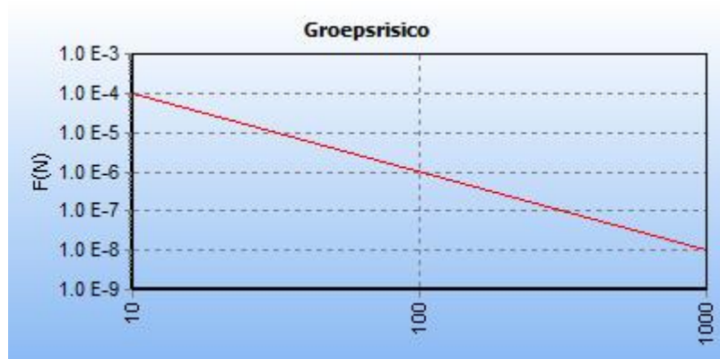
5.2 Figuur 5.2 FN curve voor 7707_leiding-Z-542-01-deel-1_excl verl van N.V. Nederlandse Gasunie voor de kilometer tussen stationing 780.00 en stationing 1780.00
