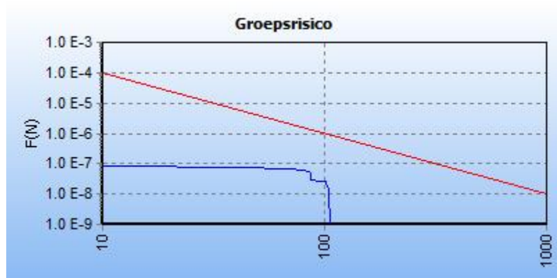
5.2 Figuur 5.2 FN curve voor 7707_leiding-Z-542-01-deel-1_excl verl van N.V. Nederlandse Gasunie voor de kilometer tussen stationing 780.00 en stationing 1780.00
