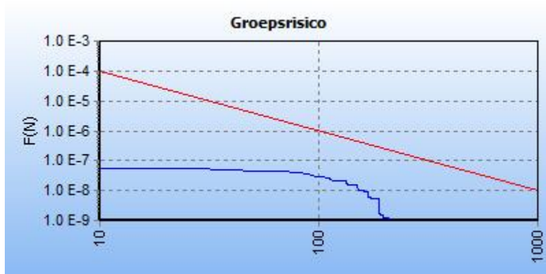
5.7 Figuur 5.7 FN curve voor 7714_leiding-Z-542-01-deel-1_incl verl van N.V. Nederlandse Gasunie voor de kilometer tussen stationing 770.00 en stationing 1770.00
