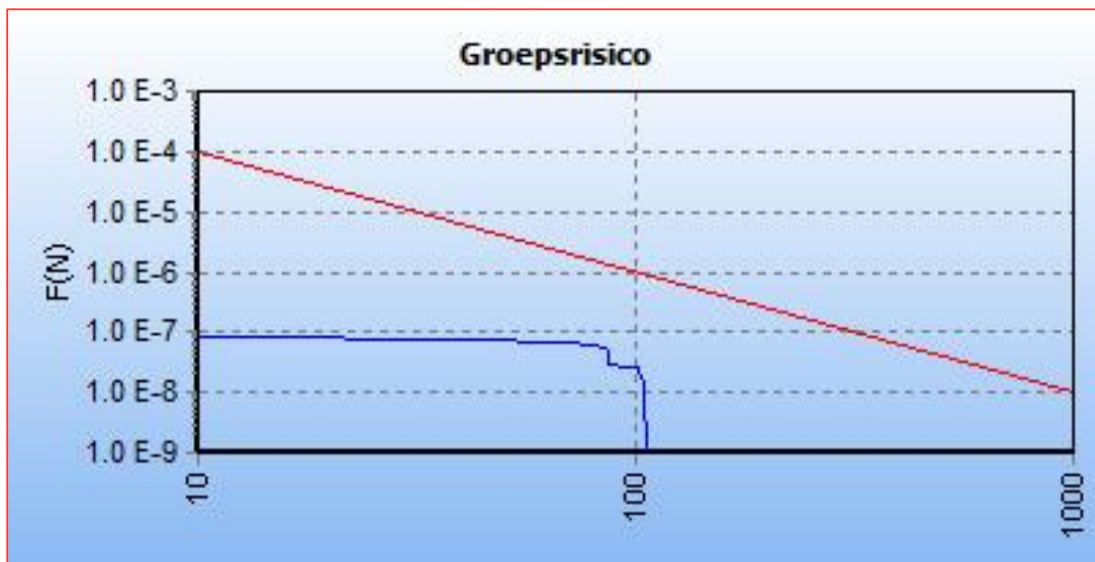
Figuur 8: FN curve voor 7707_leiding-A-521-deel-1 van N.V. Nederlandse Gasunie zonder Foodpark fase 4 populatie
