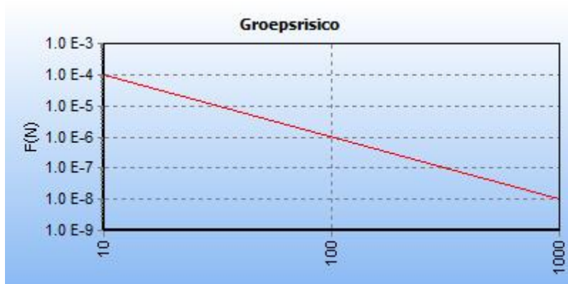
5.7 Figuur 5.7 FN curve voor 7714_leiding-Z-542-01-deel-1_incl verl van N.V. Nederlandse Gasunie voor de kilometer tussen stationing 770.00 en stationing 1770.00
