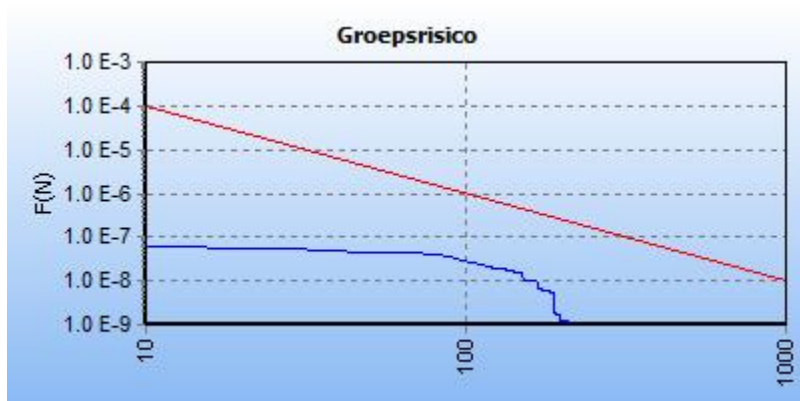
5.4 Figuur 5.4 FN curve voor 7707_leiding-Z-542-12-deel-1 van N.V. Nederlandse Gasunie voor de kilometer tussen stationing 0.00 en stationing 420.00
