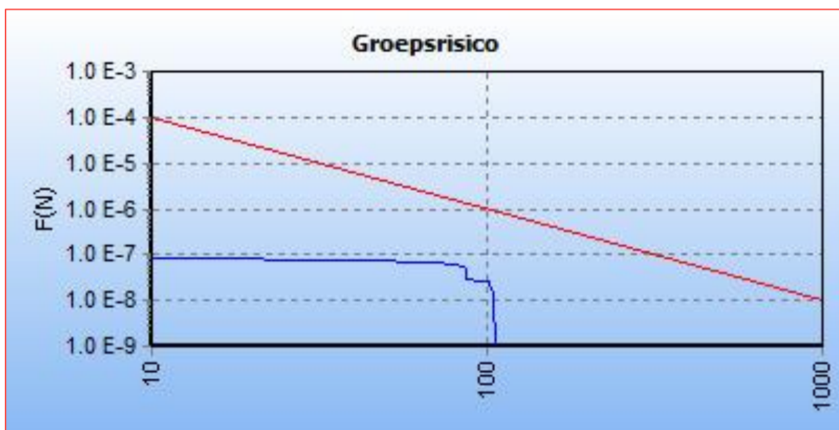
Figuur 9: FN curve voor 7707_leiding-A-521-deel-1 van N.V. Nederlandse Gasunie met Foodpark Fase 4 populatie
