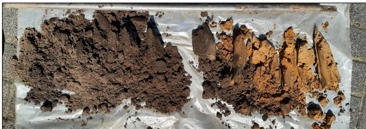
Figuur 7. Foto van boring 4. De leesrichting is van links naar rechts (0 – 110 centimeter) (Foto: 10 augustus 2023).
