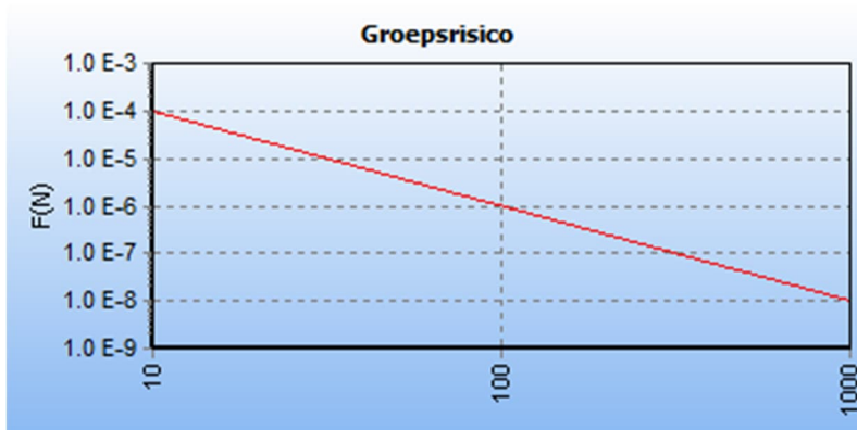
Afbeelding 7 fN-curve buisleiding Z-542-01-deel-1, huidige situatie
