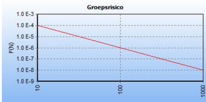
5.3 Figuur 5.3 FN curve voor 9018_leiding-Z-542-19-deel-1 van N.V. Nederlandse Gasunie voor de kilometer tussen stationing 0.00 en stationing 1000.00
