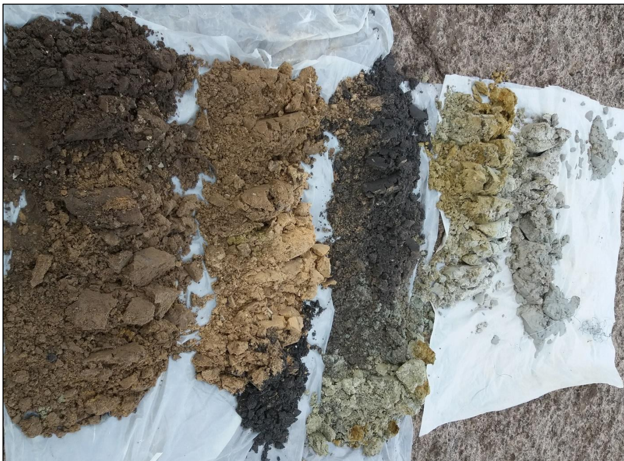
Afbeelding 6: Foto boorprofiel meetpunt 1 uitgelegd in de diepte van links naar rechts
