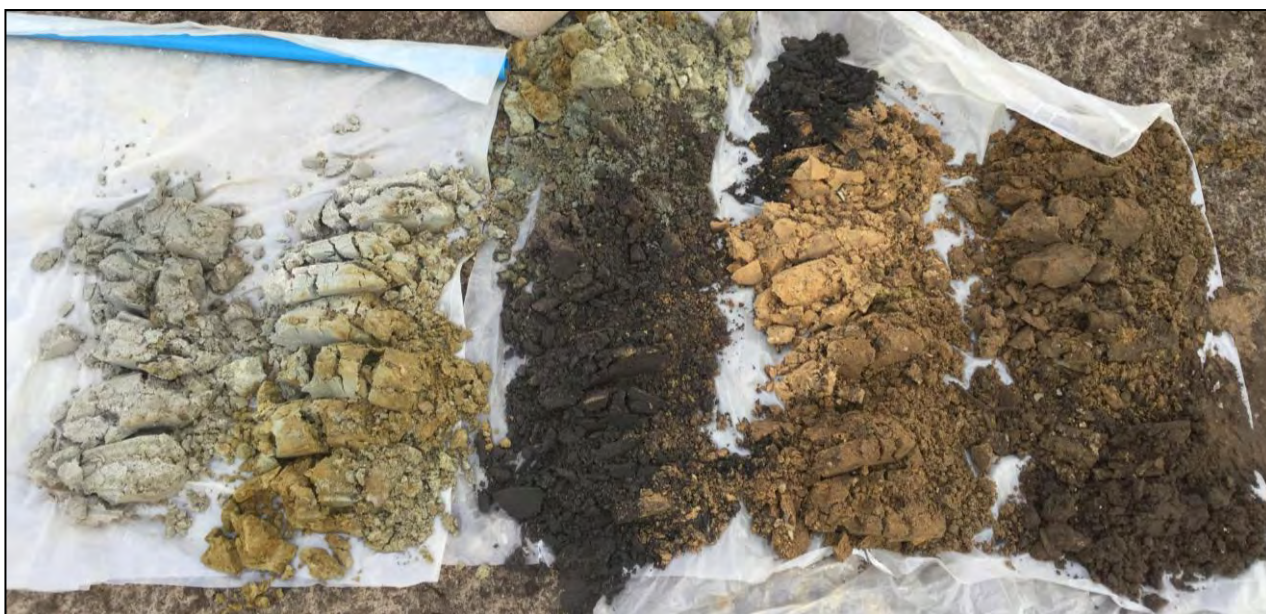
Figuur 4: overzicht boring 1 met rechtsonder de top van de boring en linksboven de onderkant.
