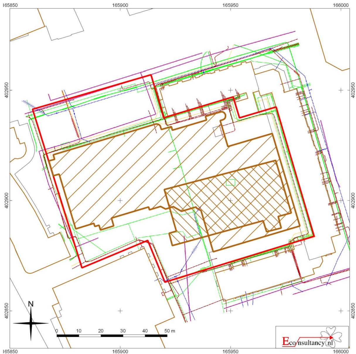
Figuur 4. Kabels en leidingen
