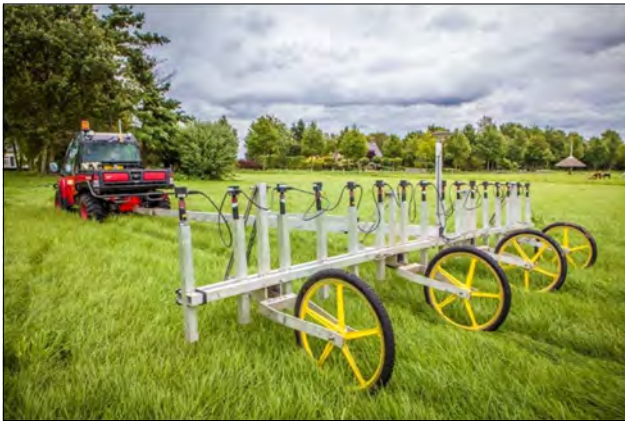
Figuur 4. Passieve non realtime oppervlakedetectie met het Vallon Multisondesysteem VXV16 en een staafdiagram waarop het maximale detectiebereik (m 2 - maaiveld) per kaliber is weergegeven.
