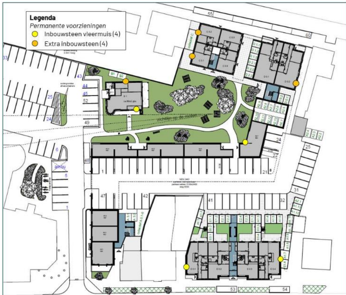
Figuur 2. Locatie van de permanente voorzieningen.
