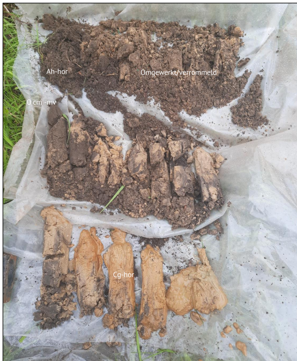
Figuur 7. Boorprofiel van boring 1. De leesrichting is van linksboven naar rechtsonder (0 – 160 centimeter). (Foto: 4 mei 2021).
