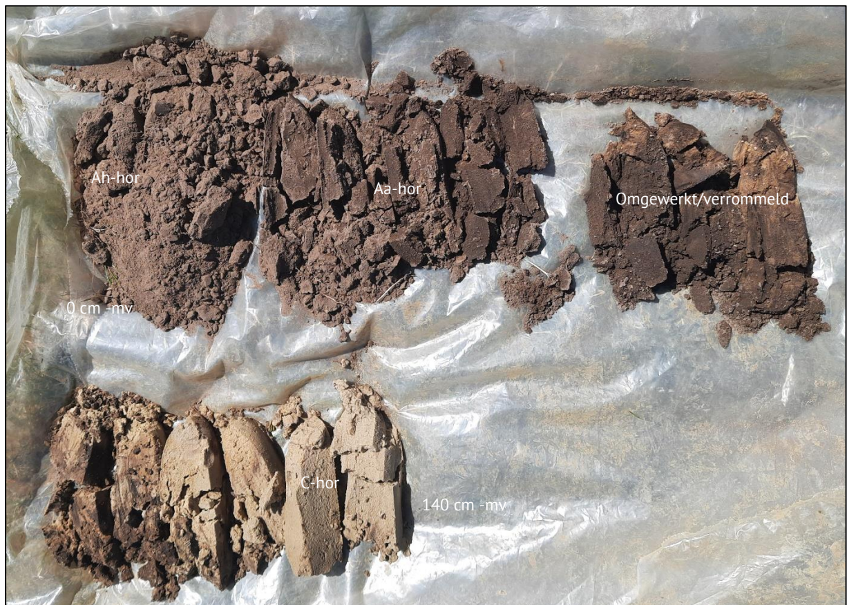
Figuur 7: Boorprofiel van boring 2. De leesrichting is van linksboven naar rechtsonder (0 – 140 centimeter). (Foto: 15 juni 2021).
