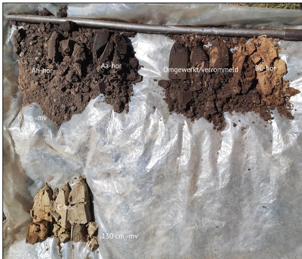
Figuur 8: Boorprofiel van boring 7. De leesrichting is van linksboven naar rechtsonder (0 – 130 centimeter). (Foto: 15 juni 2021).
