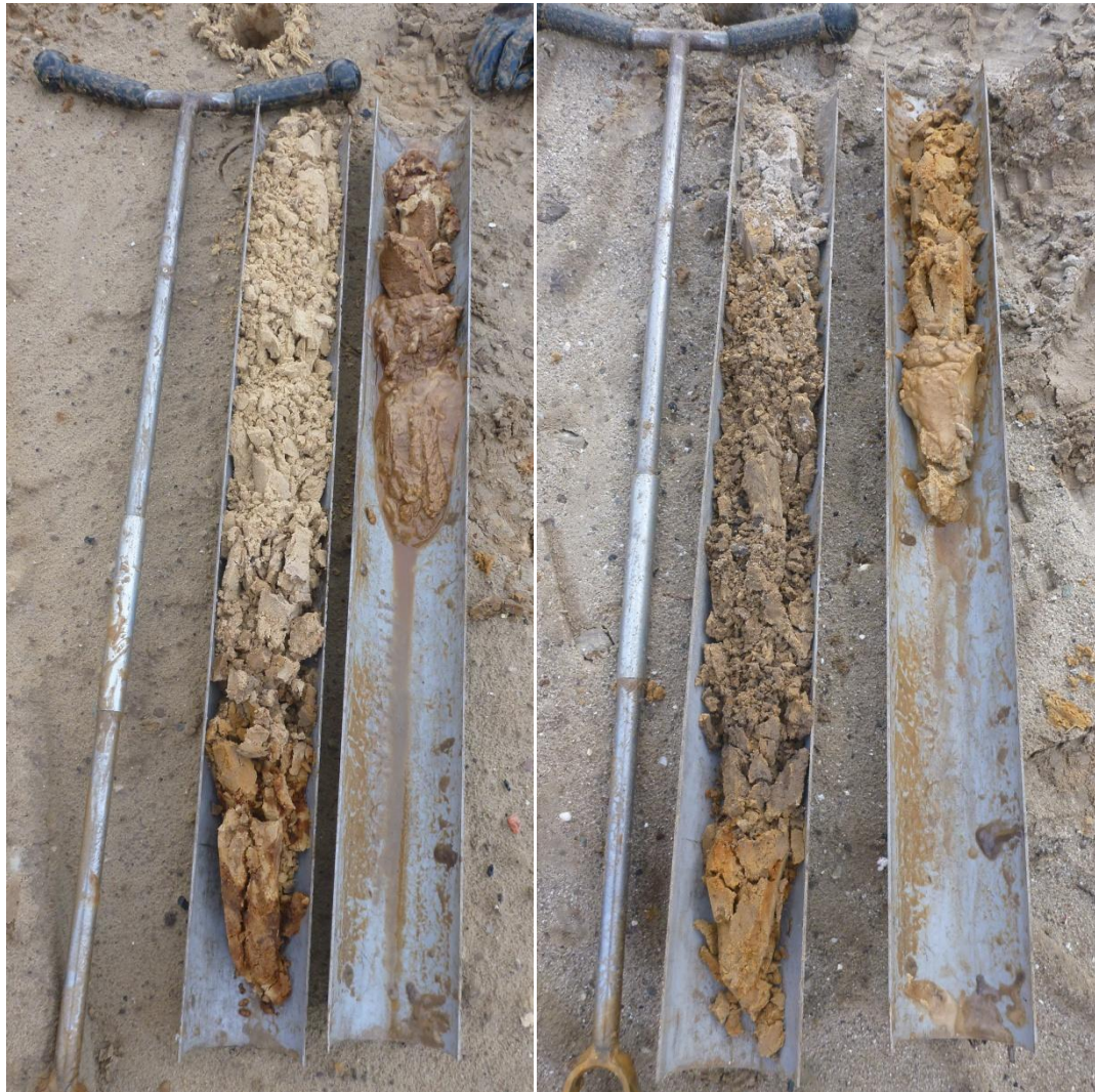
Fig. 3.3: Twee voorbeelden van een verstoord bodemprofiel: boring 3 (rechts) en boring 4 (links).
