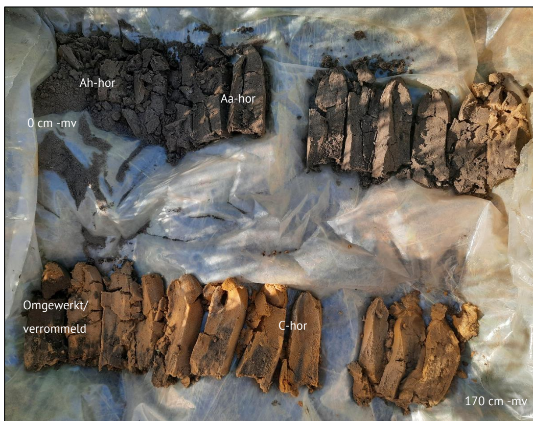
Figuur 6: Boorprofiel van boring 1. De leesrichting is van linksboven naar rechtsonder (0 – 170 centimeter). (Foto: 14 juni 2021).
