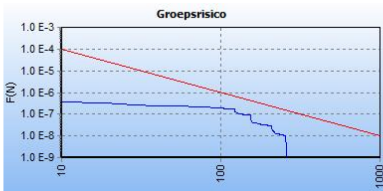
Afbeelding 5 fN-curve buisleiding A-521-deel-1, huidige situatie
