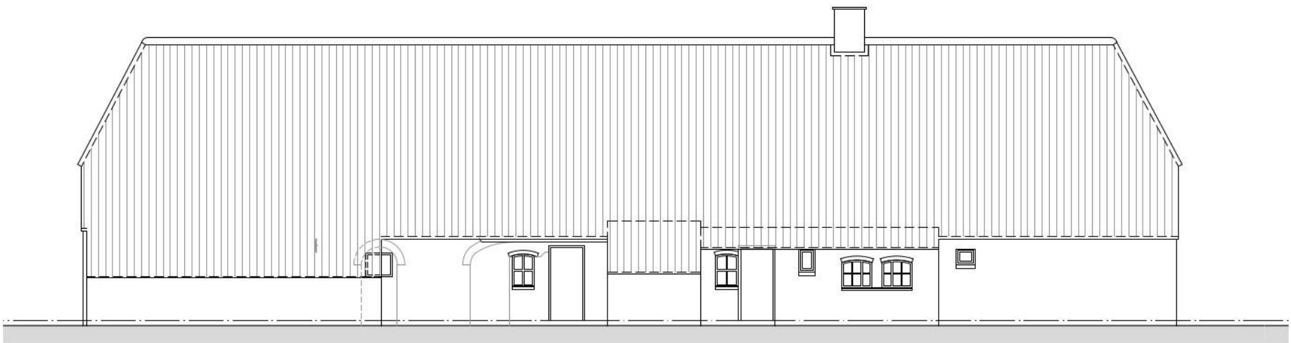
Figuur 15 - Achtergevel; bouwsporen zijn aangegeven m.b.v. grijze lijnen (bron: Van Hooft Architecten, Eerde, werknr. 3687).
