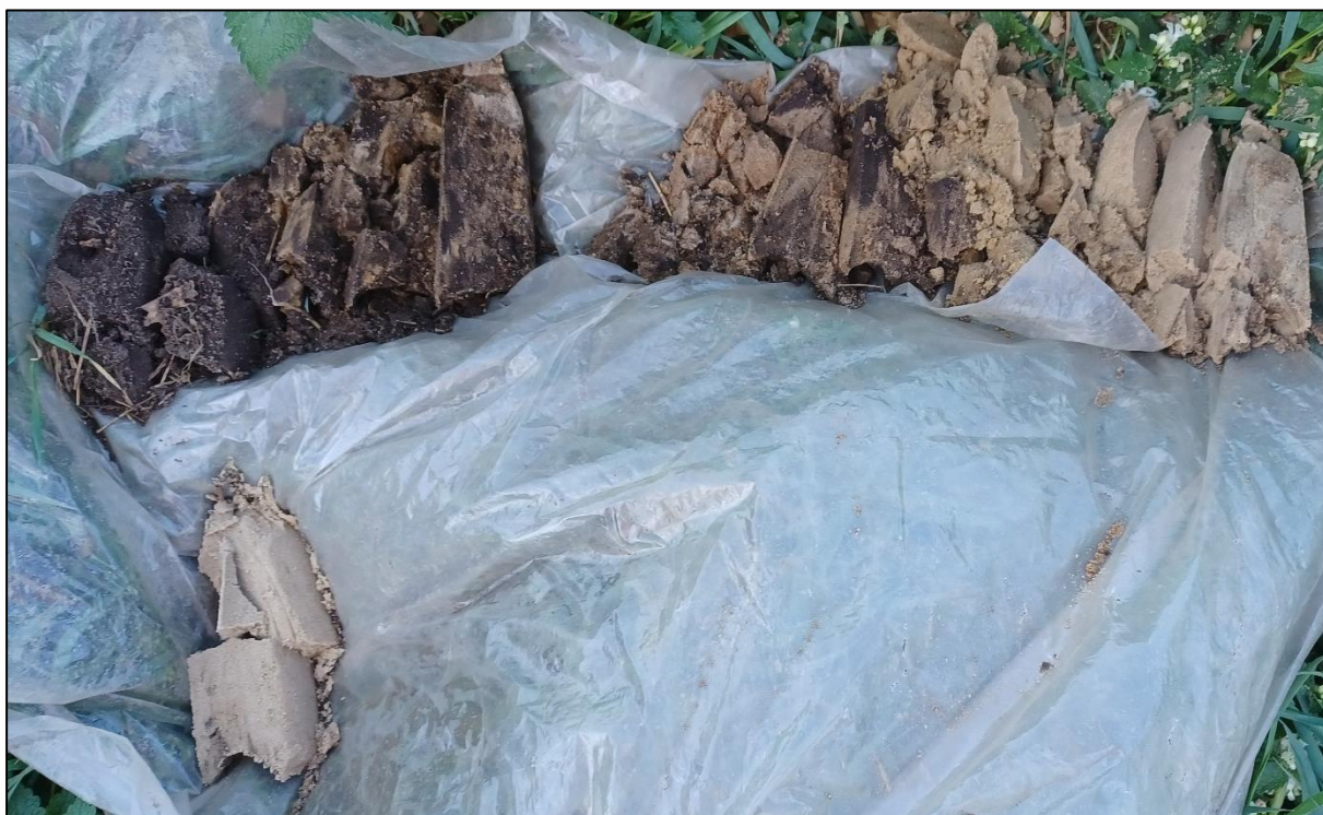
Figuur 8. Boorprofiel boring 8. Leesrichting van linksboven naar rechtsonder. (0 - 110 centimeter -mv)
