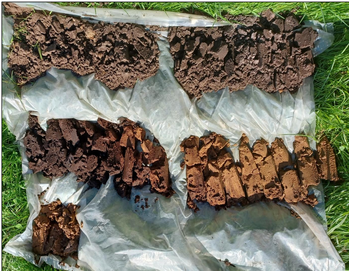
Figuur 9. Boorprofiel boring 7. Leesrichting van linksboven naar rechtsonder. (0 - 210 centimeter -mv)
