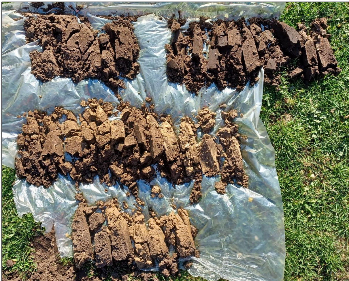
Figuur 7. Boorprofiel boring 3. Leesrichting van linksboven naar rechtsonder. (0 - 200 centimeter -mv)
