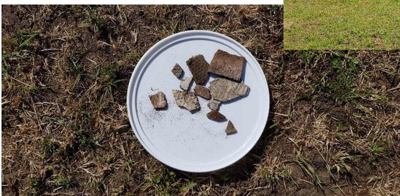
aangetroffen asbestverdachte fragmenten op maaiveld
