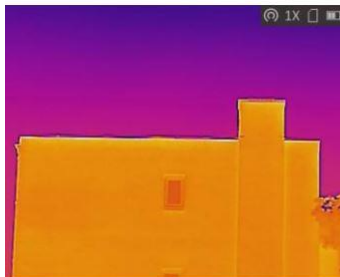
Figuur 4a: Warmtebeeld gevel
