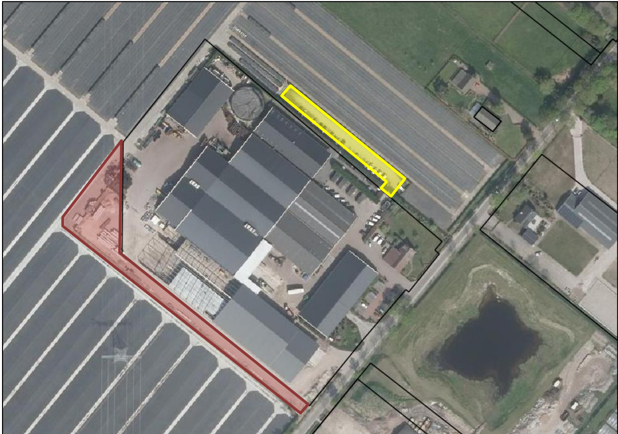
Figuur 6: Erfverharding welke buiten het bouwvlak gelegen is (rood omkaderd = gesloten verharding, geel omkaderd = semi verharding).
