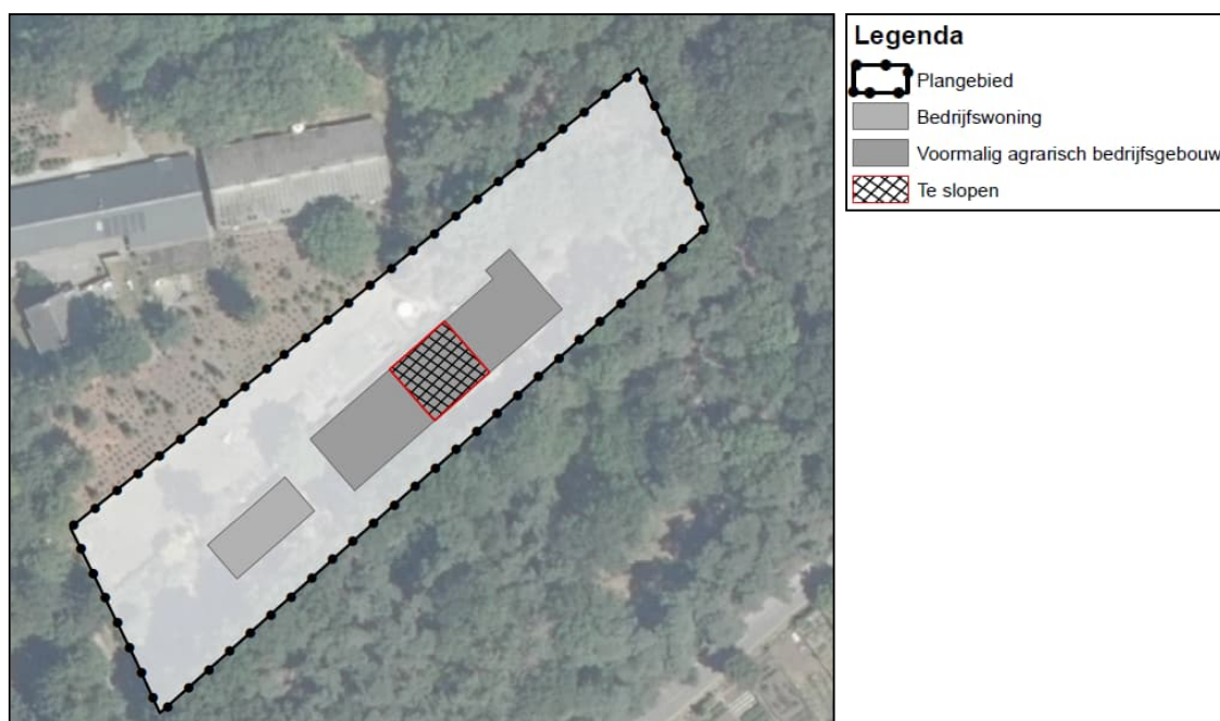
Figuur 7: Effectief te slopen bebouwing
