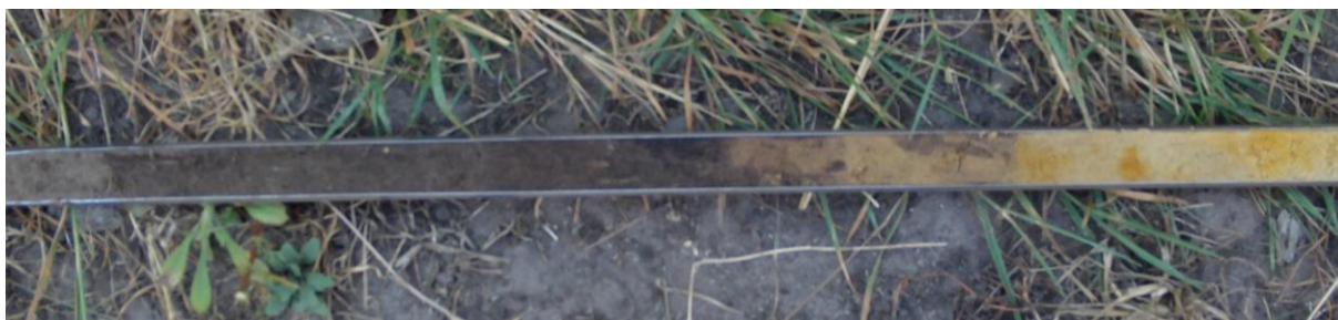
Figuur 20: Foto van boring 1 met links de bouwvoor en rechts de overgangslaag met brokken moerig zand en de gley-horizont
