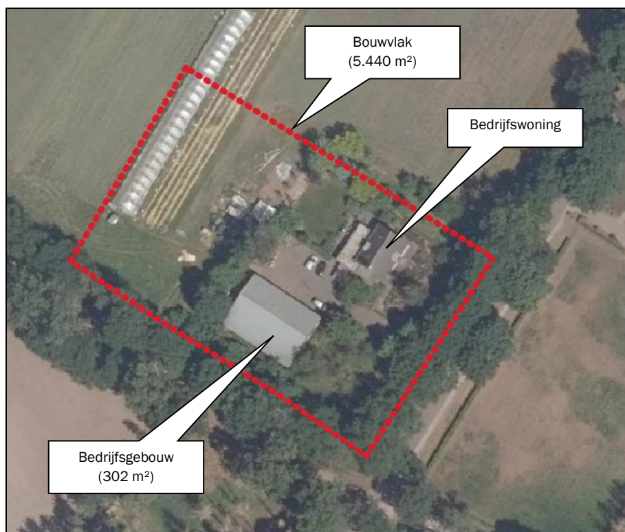
Figuur 5: Bestaande situatie plangebied
