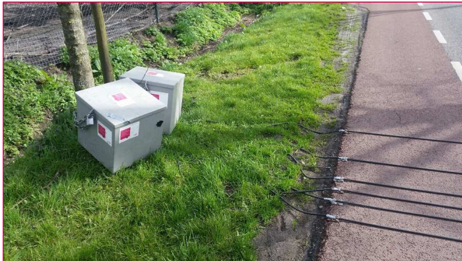
Figuur 2.1: Een van de telpunten met telslangen
