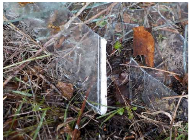
onderzoek dd 22-2-24: glas met kit op maaiveld
