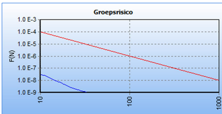
Afbeelding 7 fN-curve buisleiding Z-544-01-deel-1, huidige situatie
