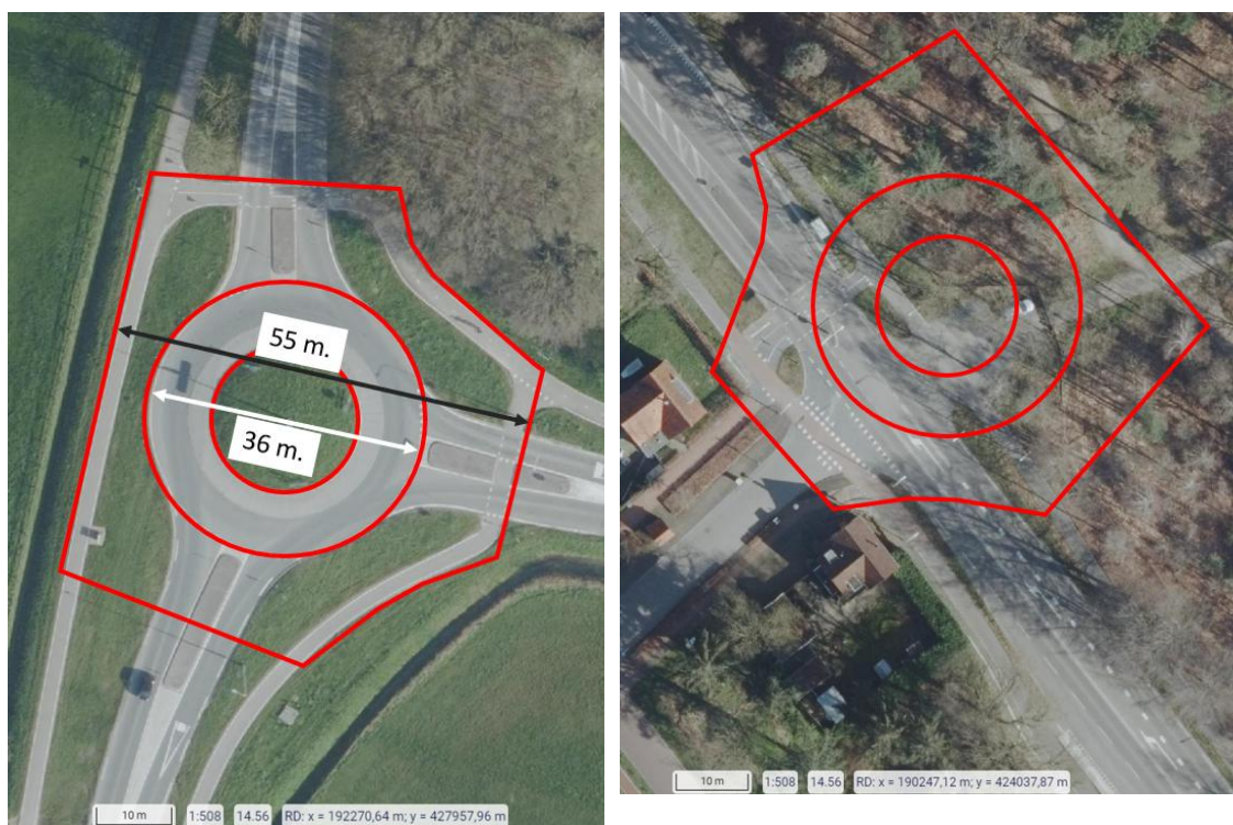
Figuur 15: Enkelstrooksrotonde Sint Hubertusweg – N840 op het kruispunt geprojecteerd.
