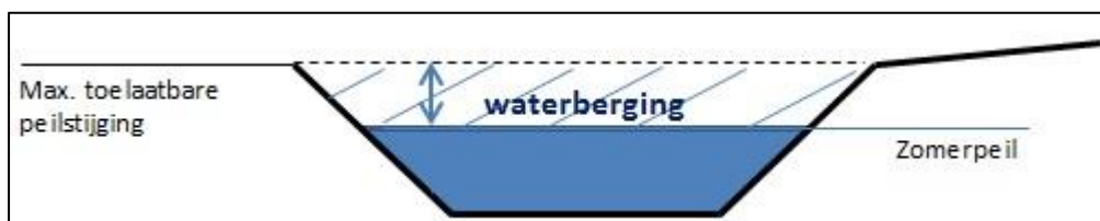
Figuur 3.1 voorbeeld waterberging in oppervlaktewater
