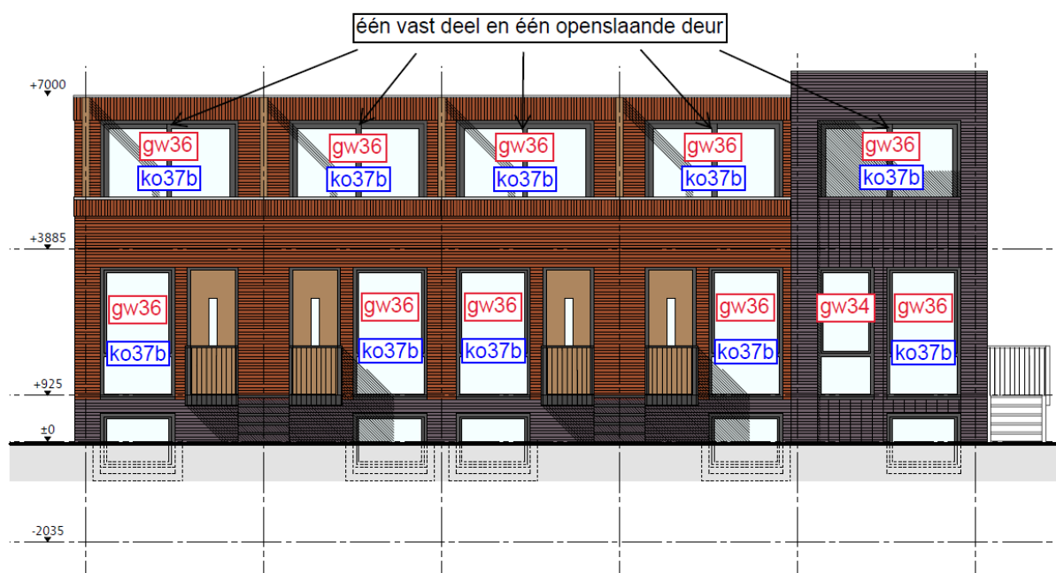
Figuur 4.1 Aanvullende voorzieningen voorgevel.
