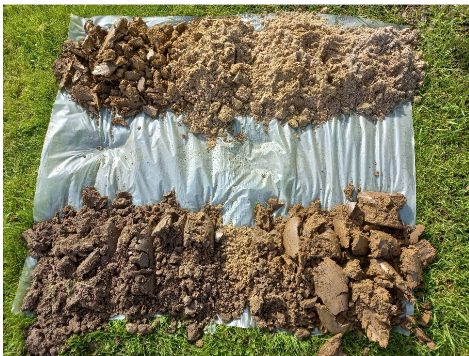
Afbeelding 4.1: Boring 16 (top linksonder, per meter uitgelegd).
