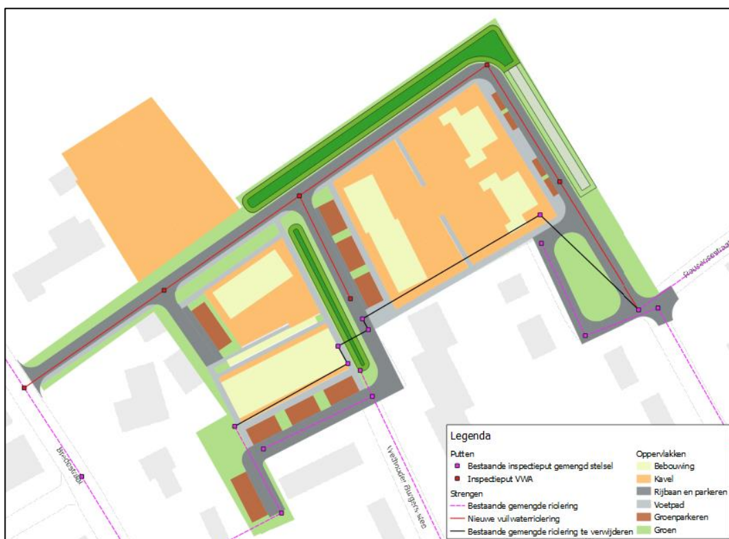
Figuur 5.1: Schematisch overzicht aansluiting vuilwaterriolering vanuit het plangebied
