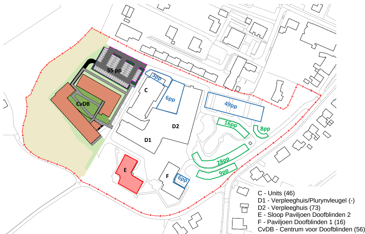
Afbeelding 2.2: Overzicht sloop Paviljoen 2
