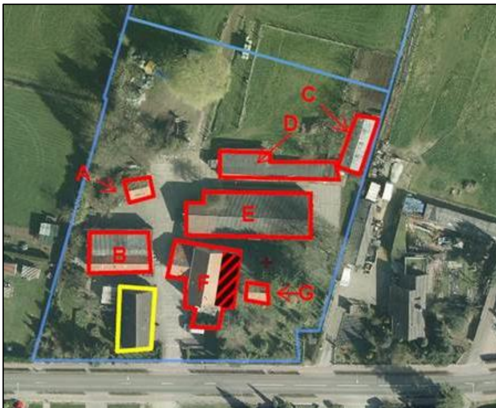
Figuur 1 De planlocatie (blauw omkaderd) is gelegen aan de Hoge Horst 47a te Groesbeek. Gebouw A, D, G en het oostelijke deel van gebouw F zijn reeds gesloopt. Gebouw B, C, E en F worden gesaneerd in de beoogde ontwikkeling. De woning (geel omkaderd) blijft behouden (bron kaartmateriaal: arcgis.com).
