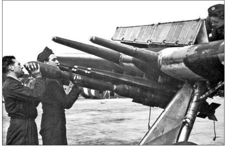
Britse SAP 60lbs lucht-gronddoel raketten werden gemonteerd onder de vleugel van Hawker Typhoon gevechtsvliegtuigen.
