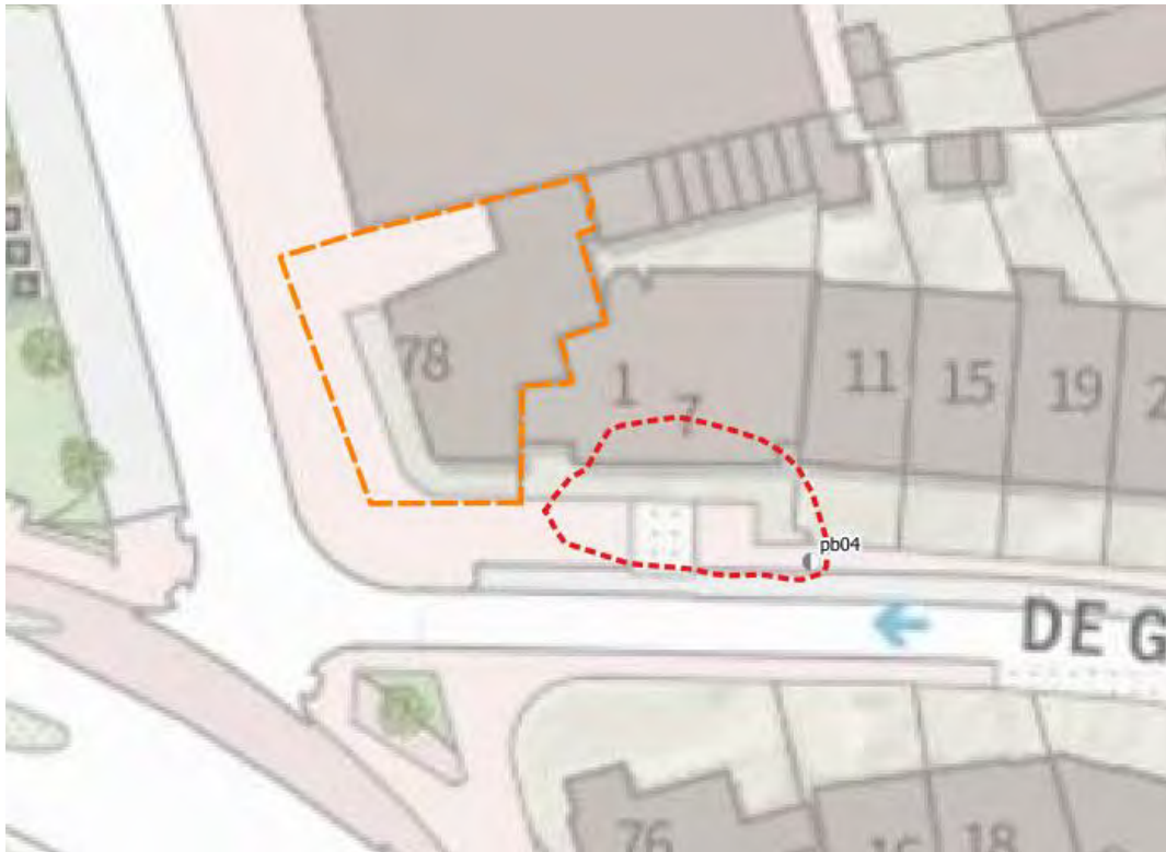
Figuur 2.3: Aangetoonde bodemverontreiniging met minerale olie en aromaten in 2004 voor onttrekking van grondwater [2]; oranje = contour onderzoeksgebied, rood = contour verontreiniging in 2004
