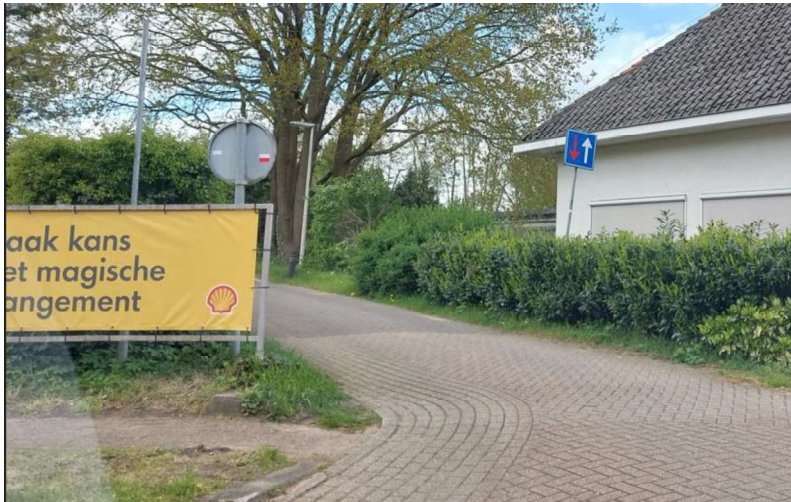
Foto 15: Slecht zicht op verkeer vanuit Melkmeent door haag en reclame uiting
