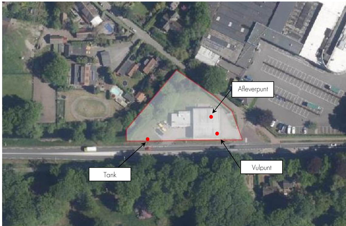
Afbeelding 4 Ligging installaties LPG-tankstation (bron: Signaleringskaart)
