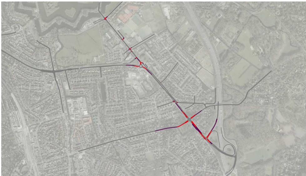
Afbeelding 5: Wachtrijlengtes (gemiddelde en 95 e percentiel) in de situatie met de BORgronden (avondspits 2030 H), inclusief kruispuntaanpassingen Brediusweg en aansluiting A1
