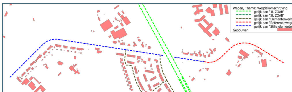
Figuur 4 Klinkerverharding vervangen door dicht stille klinkers
