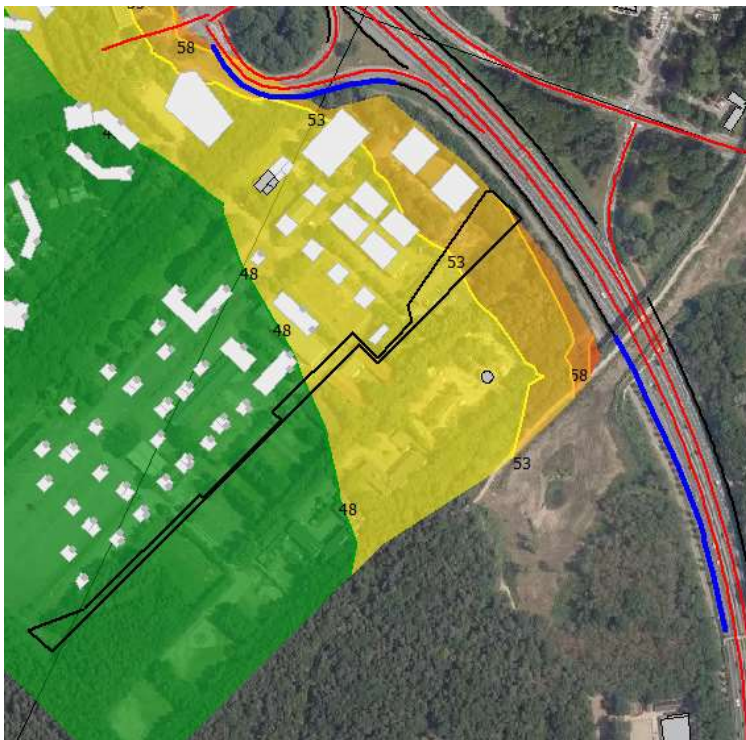
Figuur 9: poldercontour van A1 op 4,5 m hoogte grondgebied gemeente Laren na verlenging van bestaande schermen van 4,8 m hoog aan weerszijden (blauwe lijnen)
